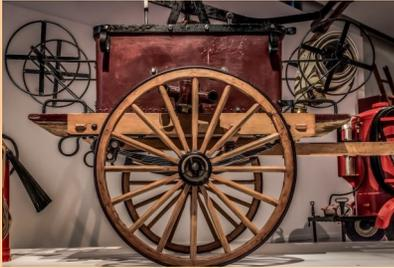
Avant 1933, la commune était probablement équipée d'une pompe à bras. Elle comprenait une cuve en cuivre ou laiton que l'on remplissait d'eau avec des sacs de toile et une pompe avec balanciers qui amenait l'eau dans des tuyaux de cuir terminés par une lance. Cette machine rudimentaire permettait d'éteindre le feu à distance.
